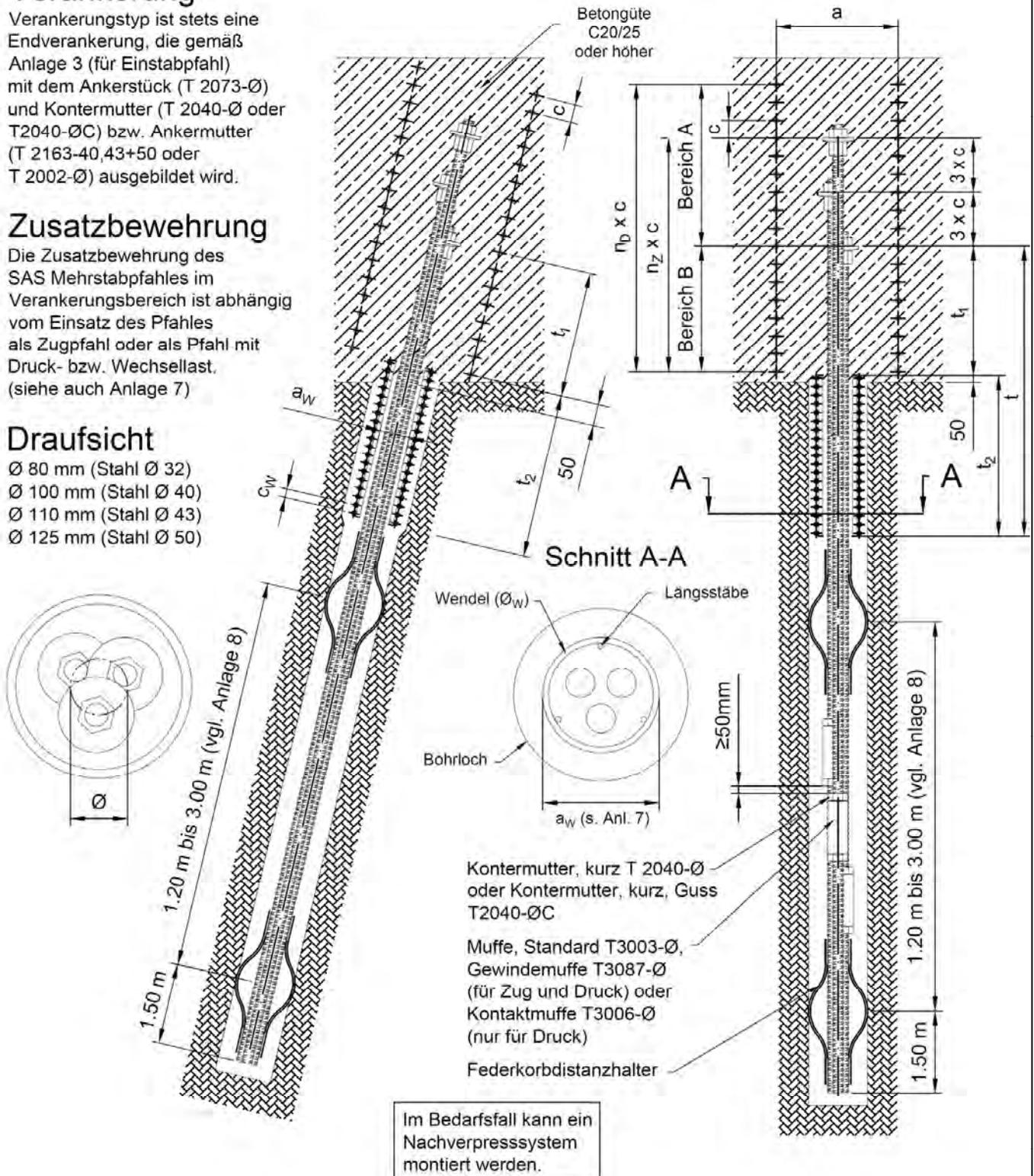
SAS Mikropfähle mit Traggliedern aus Betonstabstahl mit Gewinderippen SAS 500 (B500B); Ø 20 mm, Ø 25 mm, Ø 28 mm, Ø 32 mm, Ø 40 mm, Ø 43 mm und Ø 50 mm
