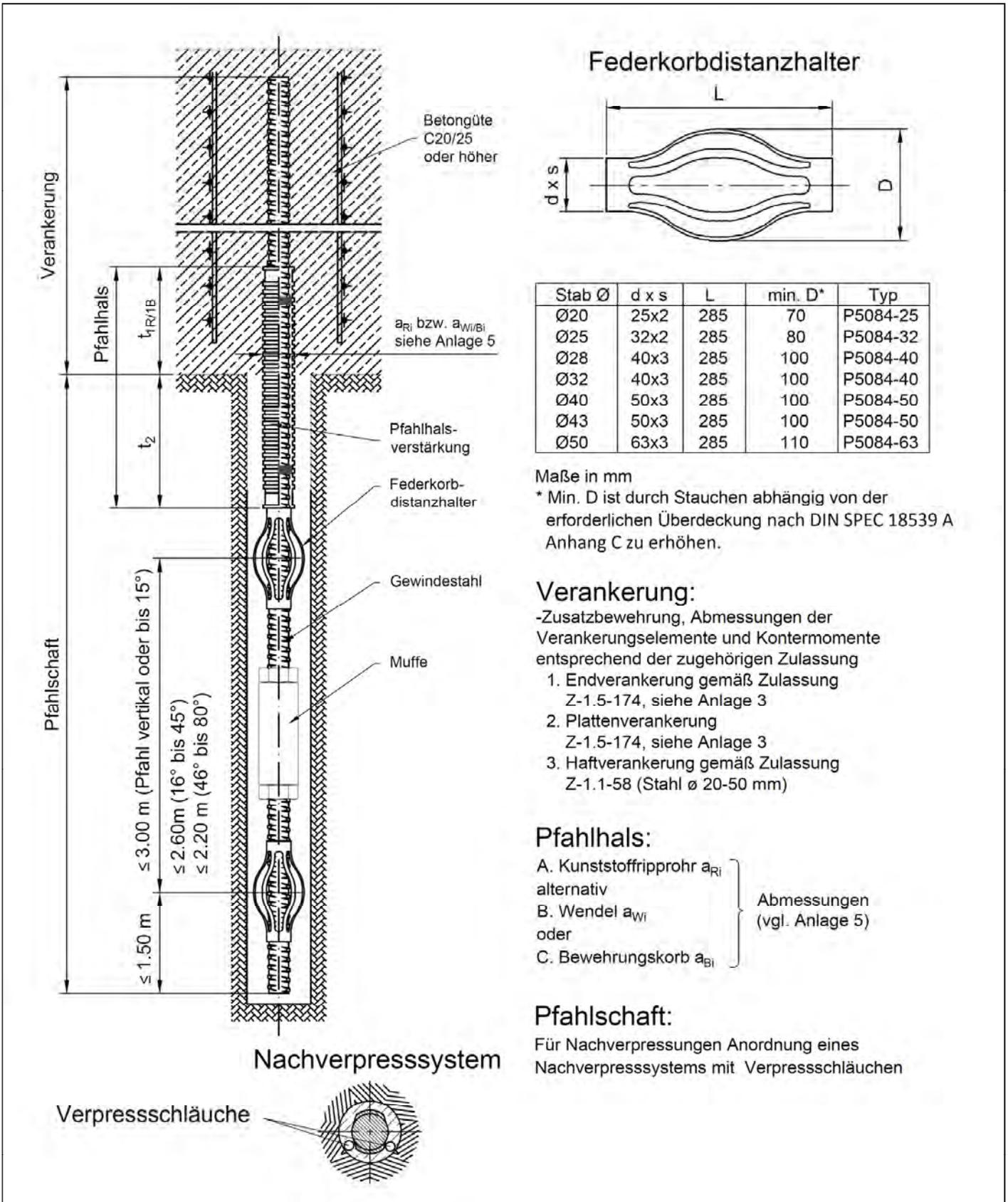
SAS Mikropfähle mit Traggliedern aus Betonstabstahl mit Gewinderippen SAS 500 (B500B); Ø 20 mm, Ø 25 mm, Ø 28 mm, Ø 32 mm, Ø 40 mm, Ø 43 mm und Ø 50 mm
